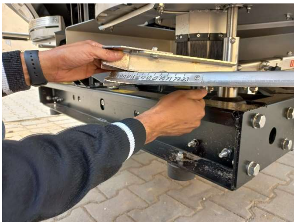
POPIS: Seřizování rozmetacích lopatek (délka a úhel) rozmetadla DCM.
